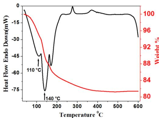
Fig. 2. TG-DTA Plots of  $60V_2O_5-5P_2O_5-35B_2O_3$  glass.
