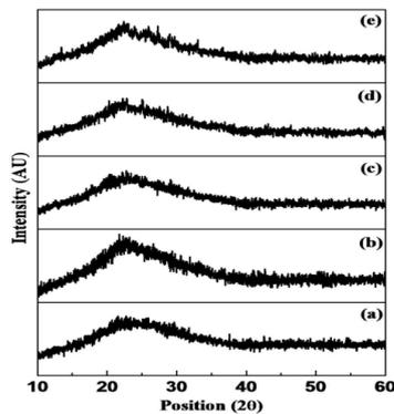
Fig. 1. XRD of  $60V_2O_5-(40-x)P_2O_5-xB_2O_3$  for (a)  $x=5$  mol %, (b)  $x=10$  mol %, (c)  $x=20$  mol %, (d)  $x=30$  mol % and (e)  $x=35$  mol %.
