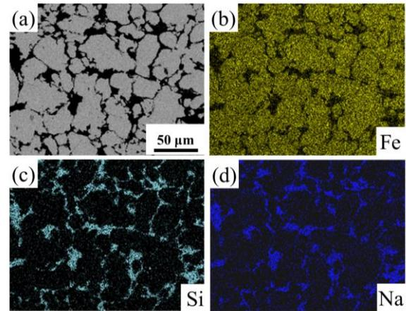
Fig. 3. Morphology and element distribution in  $Fe/SiO_2-Na_2O-CaO$  composites, (a) microstructure, (b) Fe, (c) Si, (d) Na.
